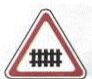
1.1 Железнодорожный переезд со шлагбаумом
